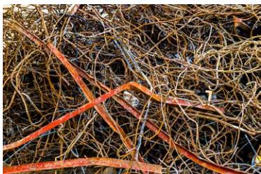
団子鉄筋屑等で、肉厚が概ね3mm以上6mm以内ある鉄のうち、長さが概ね1～1.5m以上であるためギロチンにより切断 しなければの製鋼所の釜に入れることができない品物。
